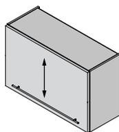
Регулировка по вертикали (HV)
